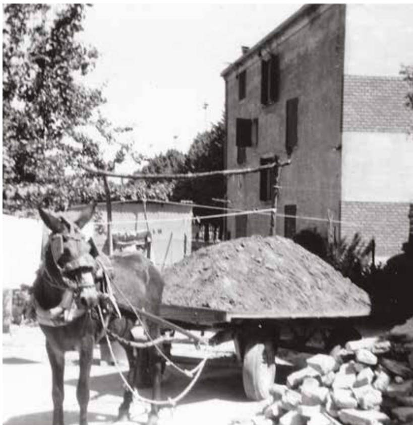
Carro senza sponde a traino animale, dotato di ruote gommiate e treno anteriore sterzante. Prima della meccanizzazione il mestiere del carrettiere era molto diffuso e praticato
