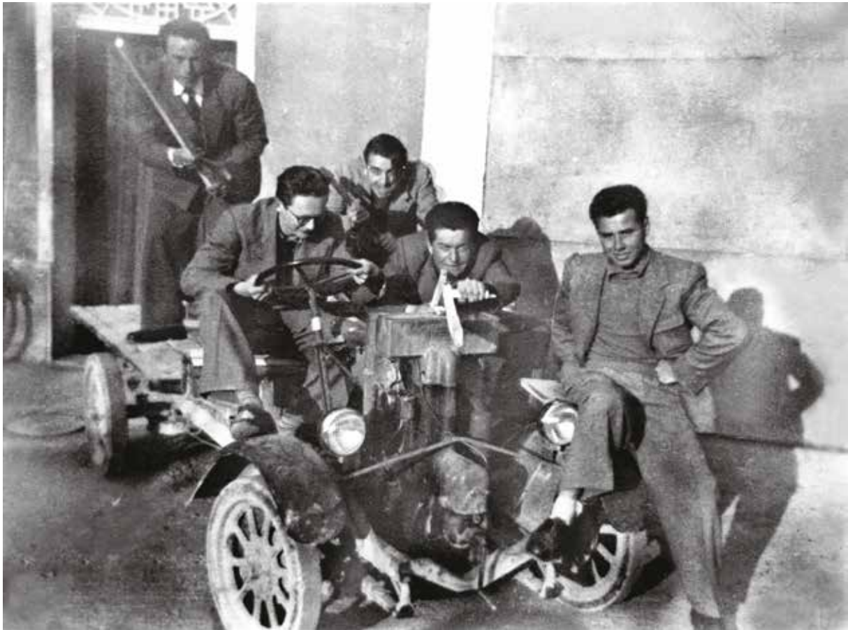
Curioso mezzo semovente assemblato con pezzi di recupero e parti di varia provenienza, si notino le ruote con gomme piene e l'avviatore a manovella (Anni '40 del Novecento)
